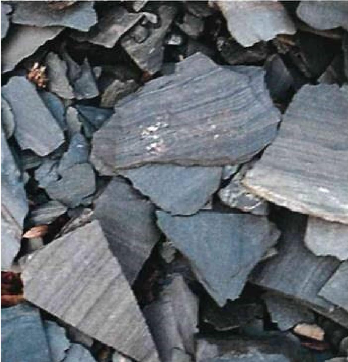
Abb. 3: Langhecker Schiefer mit typischer Streifung durch Materialwechsel (Rothe 2019)
