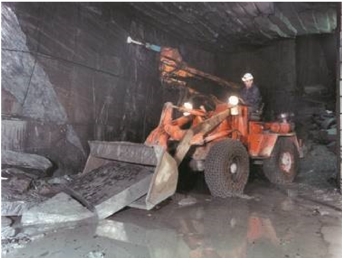
Abb. 6: Untertage.Abbau von Schieferblöcken
